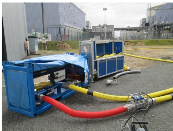
Filtre avec dispositif d'auto-nettoyage : 100 microns
