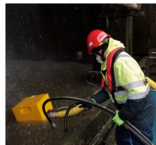
Filtre avec dispositif d'auto-nettoyage : 100 microns
