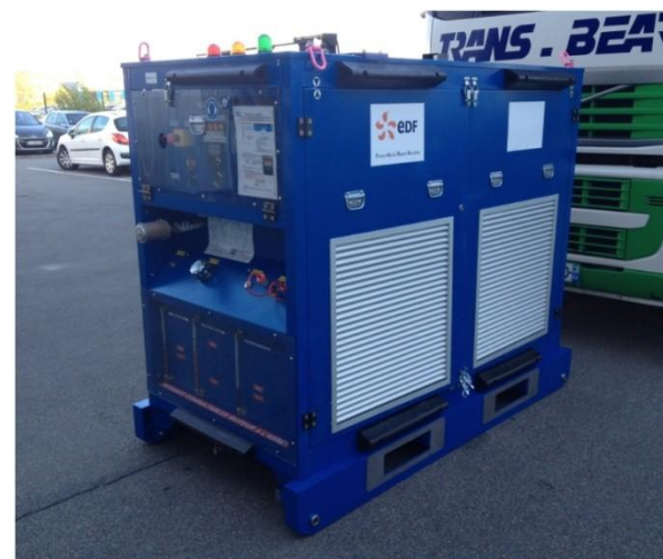
Compresseur d'air: 7 bar, 24 m 3 /h, 0.8T
