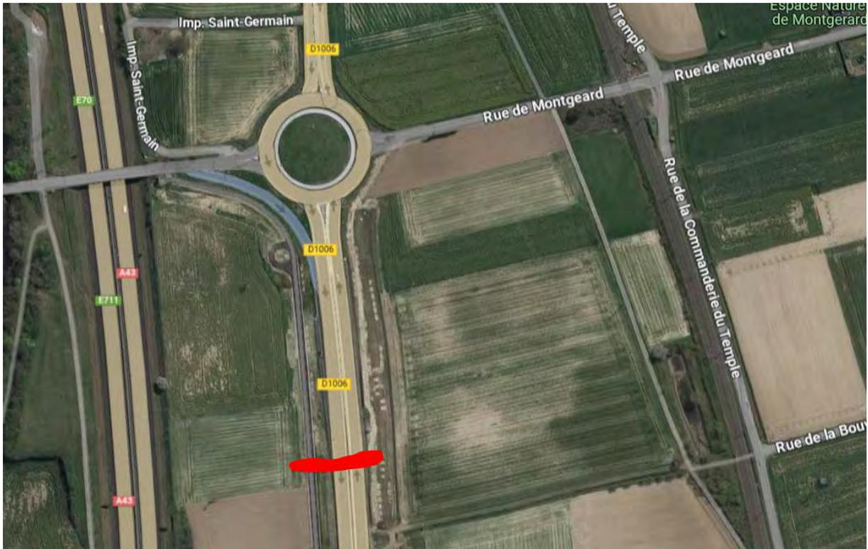
Il y aura un opérateur dans une nacelle élévatrice sur la route à coté du poteau et coupera les câbles (flèche rouge). Une fois au sol, des opérateurs seront placés dans le champ à droite et sortiront les câbles de l'emprise de la voirie. Il faut prévoir 5 minutes maximum de coupure dans les 2 sens pour évacuer les 3 câbles ou alors on peut faire 3x3 minutes.
